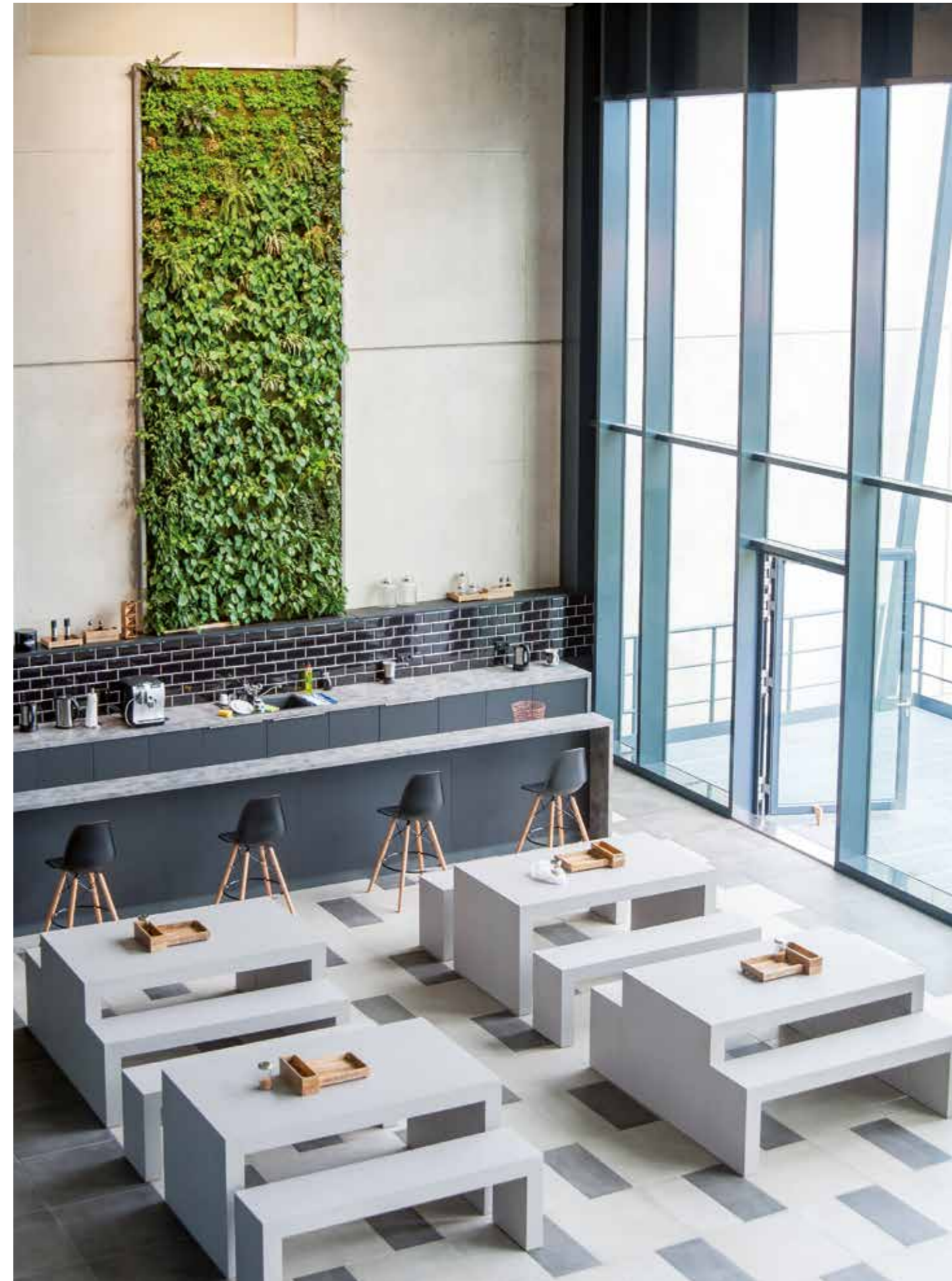
Live Panel mit vollautomatisierter Bewässerung, Projekt: Clinton, in Zusammenarbeit mit Architekturbüro Kaiser, Format: 7000 x 2000 mm, Foto: Andreas Schwarz für Freund GmbH
