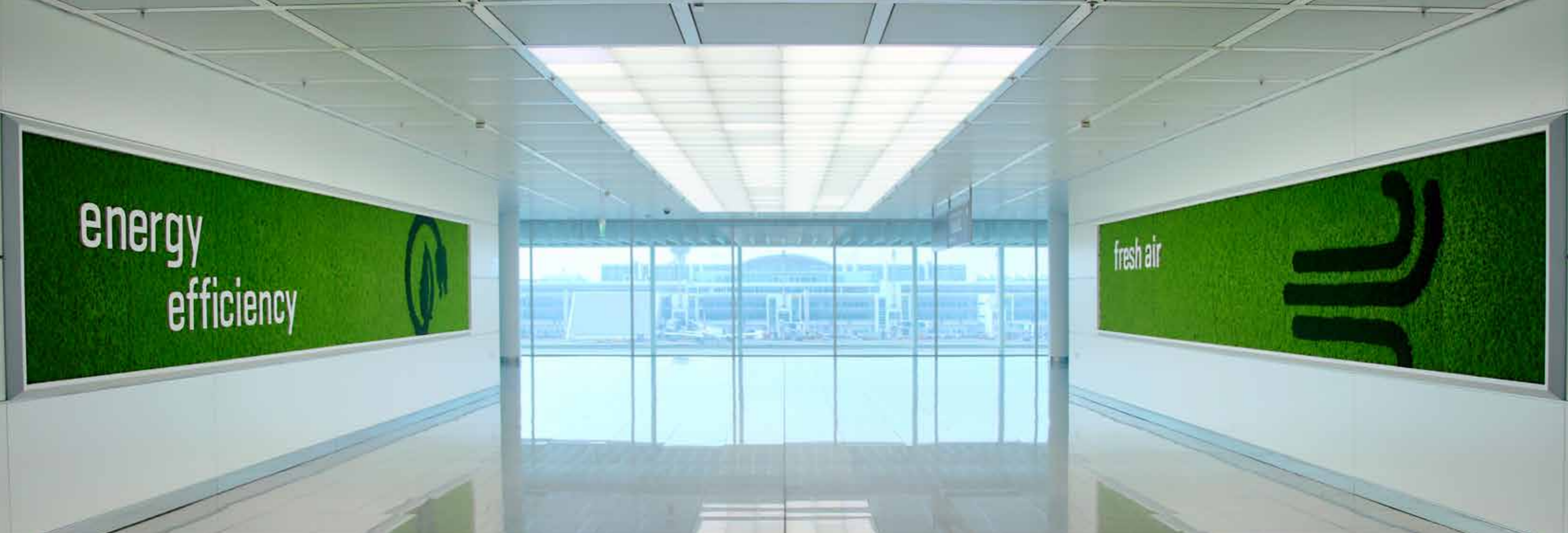
Mosowände aus Evergreen Moos Premium in B1-Ausführung „schwer entflammbar“ mit A2-Trägerplatte, Farben: apfelgrün und moosgrün, Projekt: Flughafen München Terminal, in Casa Castello, Foto: Diether Kinzel / Trick17
